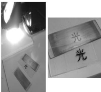
圖 3b. 光觸媒反應的光氧化現象
