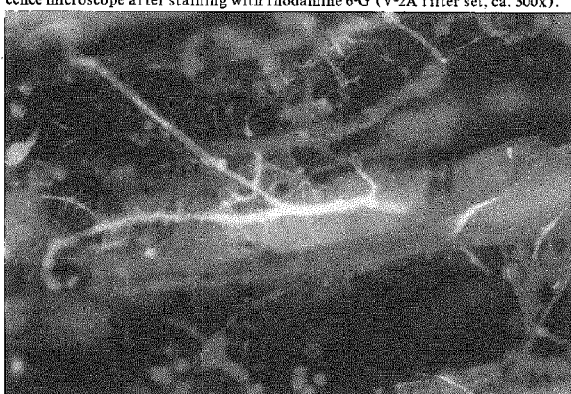
圖11 直幹相思樹木片接種 C. versicolor 30日，並感染疑似 Trichoderma 菌，經 malachite green, acridine orange 及 calcofluor 複式染色後之螢光顯微照片，兩種菌絲分別呈紅棕色及藍白色(V-2A濾鏡組，ca. 300x)。
