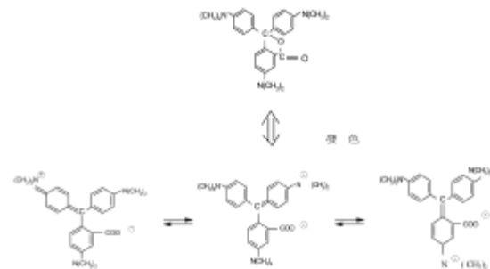
圖 9 氧化還原染料(Leuco Dye)的發色機制
