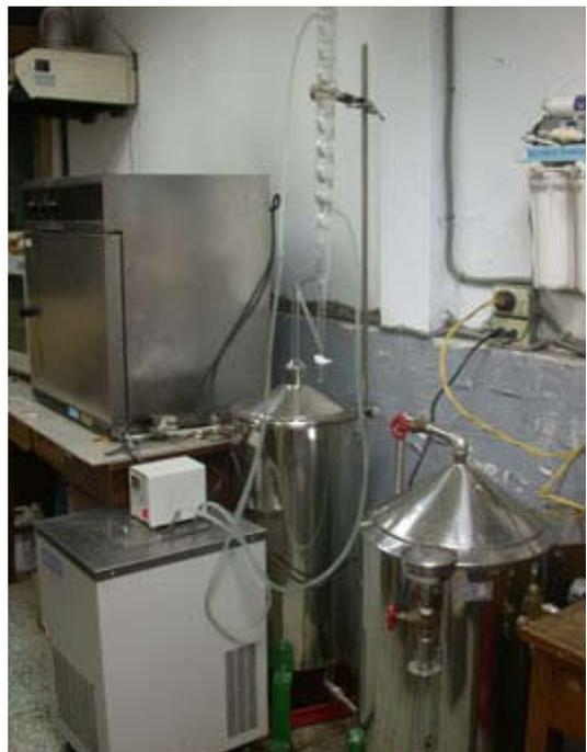
圖2 水蒸氣蒸餾法萃取裝置(李淑靜 攝)
