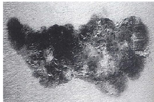
圖 35 氣泡、溶存氣體與疎水性物質結合所形成之粒子塊(ライナー&石原, 2003)
