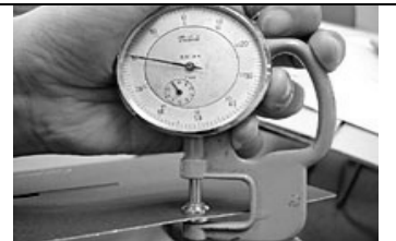
圖 6. G 楞瓦楞紙板 (楞高約 0.8mm)
